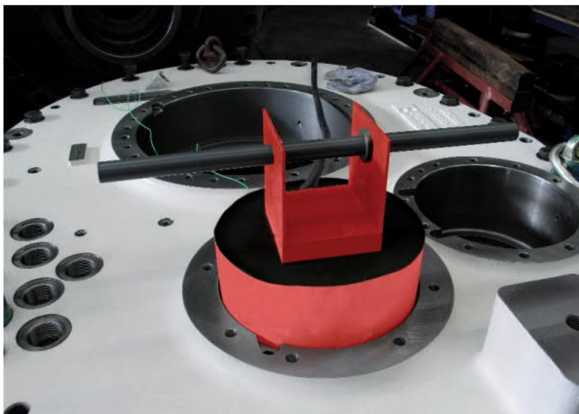
壳体内孔的加热 适用轴承与销栓的安装。
